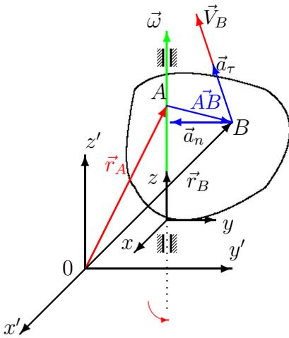
В выражении (49)  $a_\tau$  называется *вращательным* ускорением в точке  $B$ , направление которого совпадает с направлением скорости точки  $B$ ,  $a_n$  называется *осеостремительным* ускорением в точке  $B$  и направлен к оси вращения.
